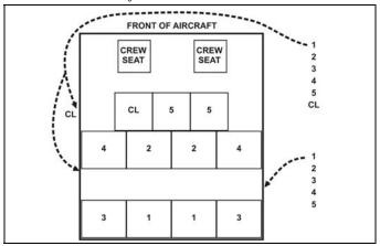
Figure 8-10. UNLOADING SEQUENCE
