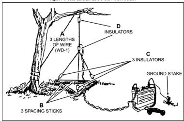
Figure 7-9. COMPLETE EXPEDIENT 292-TYPE ANTENNA
